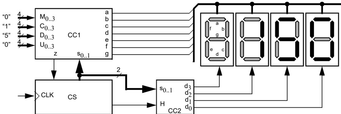
El circuito se compone de tres subcircuitos: CS, CC1 y CC2. CS es el controlador del sistema, CC1 es, básicamente un decodificador de siete segmentos y CC2 un seleccionador de visualizador (los visualizadores disponen, además de las entradas correspondientes a cada segmento, una línea de habilitación).
