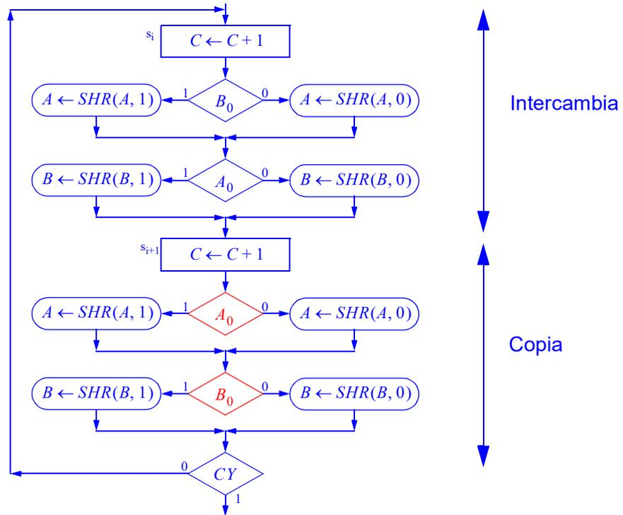
La versión final de la carta ASM fusiona esos dos comportamientos en función de la entrada I. Si I=0, hay que hacer 16 iteraciones del bucle mostrado en la primera figura. Si I=1, 8 iteraciones del bucle de la segunda figura, ya que procesa 2 bits en cada vuelta, uno para
