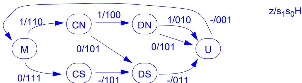
Si intentamos minimizar al máquina de estados, podemos ver, por simple inspección que la máquina es mínima, ya que no hay dos estados con las mismas salidas.
