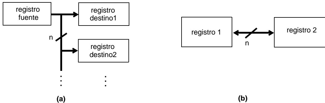
Figura 1.15: (a) Bus unidireccional. (b) Bus bidireccional.
