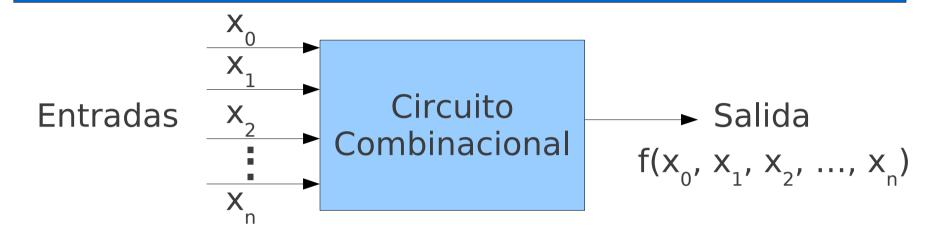
**Definición**: Una función de conmutación es una aplicación f:  $B^n \rightarrow B$ .  $f(x_0, x_1, x_2, ..., x_n)$
