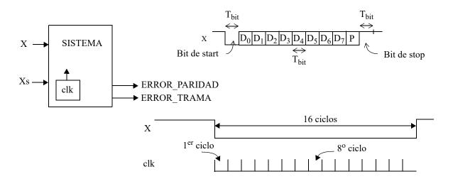
Se desea diseñar un sistema digital capaz de recoger los bits de datos en este formato y almacenarlos en el registro RCREG. El reloj del sistema es mucho más rápido que la señal X; en concreto, el periodo es de T<sub>bit</sub>/16, esto es, existen 16 ciclos de reloj por cada bit de entrada. Tras la activación de la señal Xs el sistema operará de la forma siguiente:
